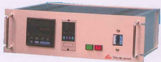
専用温度コントローラー 19ラック・JIS取手付480タイプ 定電力位相制御サイリスター搭載
