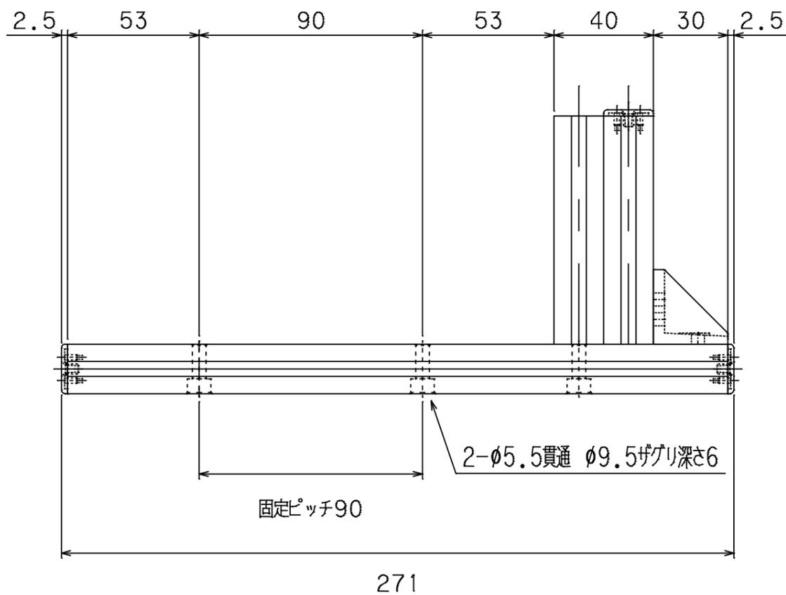
※治具固定用ナットプレート (各3ヶ所:M5) 付属
